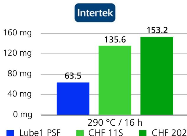
Messbedingungen: Prüfung im modifizierten Komatsu Hot Tube Tester mit 0,34 mL Öl/h und 10 m Luft/min.
